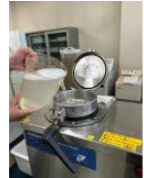
トレイを装置にセットし た後、AD溶液2Lを加 える。点数が少なくても、 1.5Lは加える。
