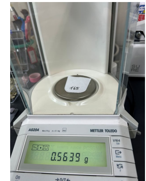
デシケータに入れて運搬 後、FB + AD残さの合 計乾燥重量を記録する (小数4けた)。
