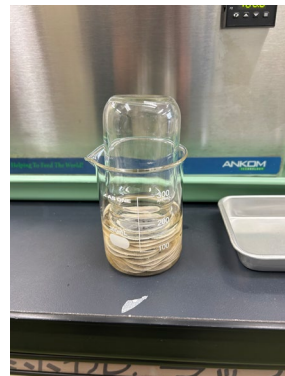
FBをアセトンに3分間 浸漬した後、トレイの上 で1時間ほど乾燥させ る。
